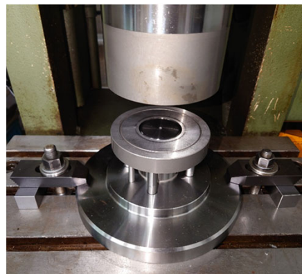
<25トンクランクプレスにセットしたレンタル用金型>
