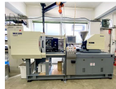
プラスチック電動式射出成型機（30t） 日精樹脂工業製【NEX300】
